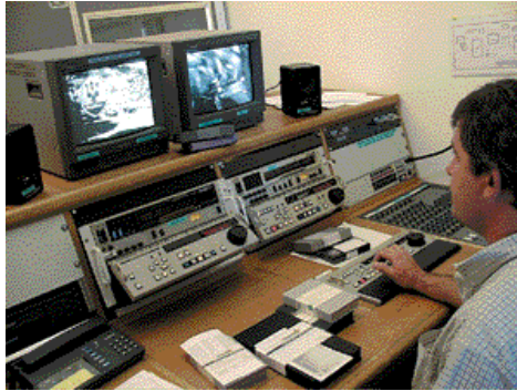
Montage 3 machines en régie
